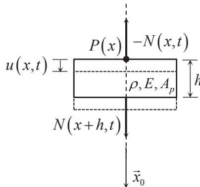
**Figure 10** – Équilibre d'un tronçon de poutre infinitésimal
