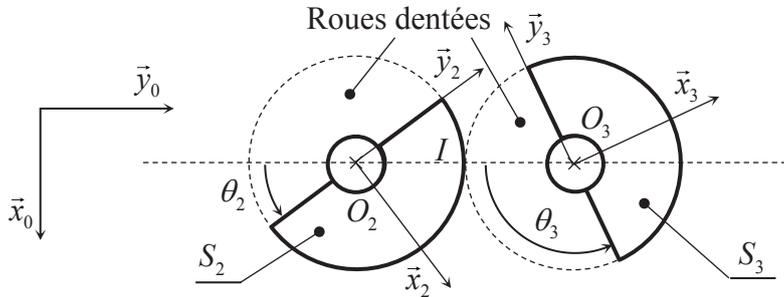
**Figure 4** – Disposition des masselottes et des roues dentées
