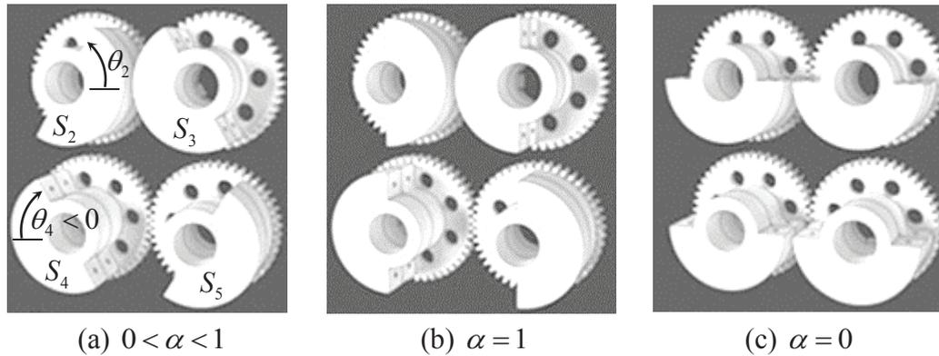
**Figure 5** – Disposition des masselottes et des roues dentées
