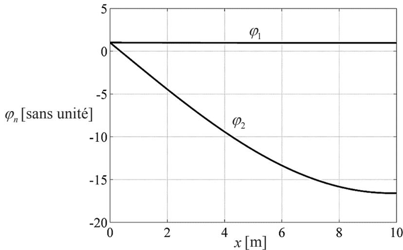
Figure 12 – Déformées propres
