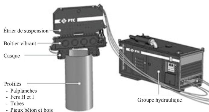
(b) Schéma d'un dispositif complet
