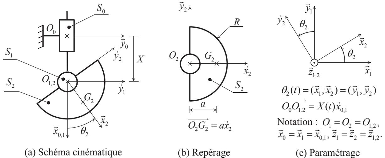
**Figure 3** – Modèle cinématique d'un vibrateur à masselotte unique
