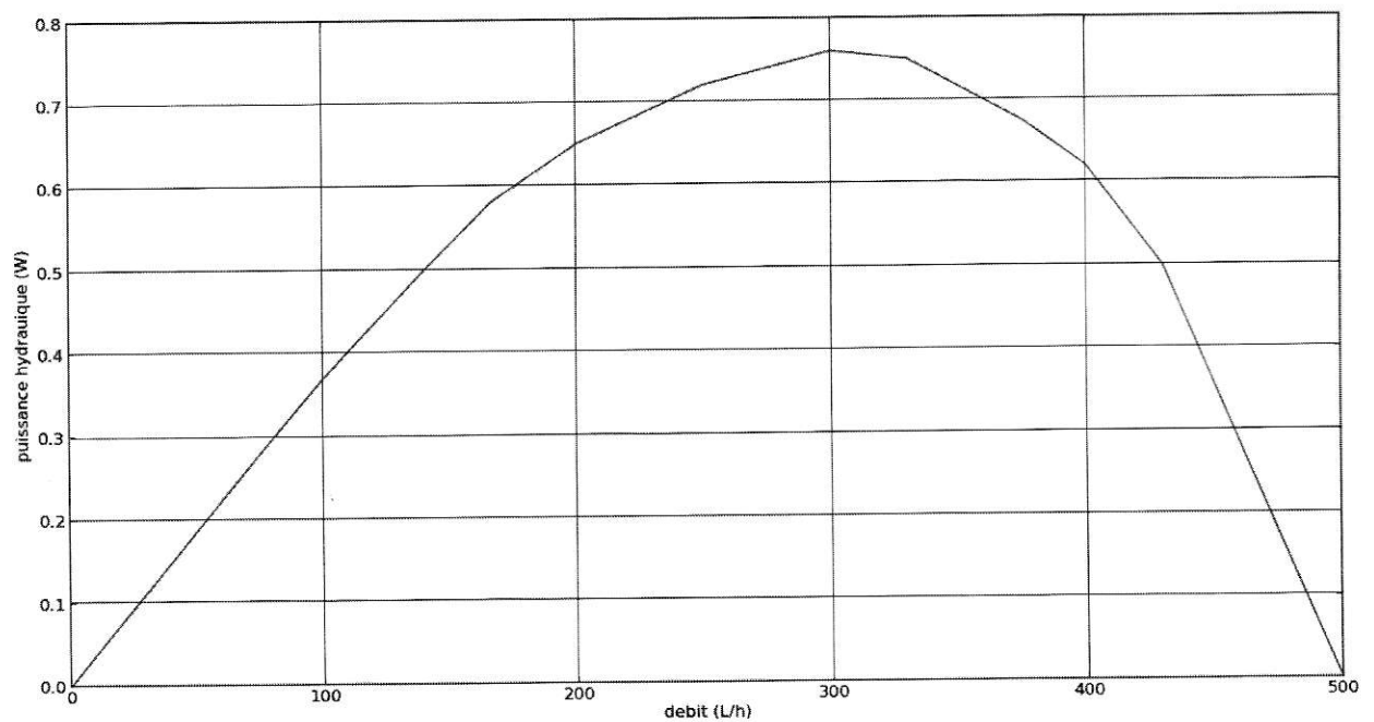
Figure 23 - Puissance hydraulique en sortie de pompe
