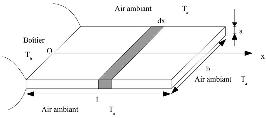
Pour éviter un échauffement de l'interrupteur trop important, on peut munir son boîtier d'ailettes de refroidissement métalliques homogènes de conductivité thermique  $\lambda'$ , de capacité thermique massique  $c'$ , de masse volumique  $\rho'$ . Chaque ailette est parallélépipédique, de dimensions : épaisseur : a, largeur : b et longueur : L.
