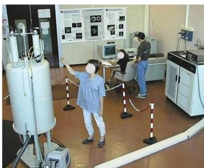
Figure 1. Appareil de spectroscopie RMN (à « 500 MHz »), console de contrôle et armoire électrique (de gauche à droite).
