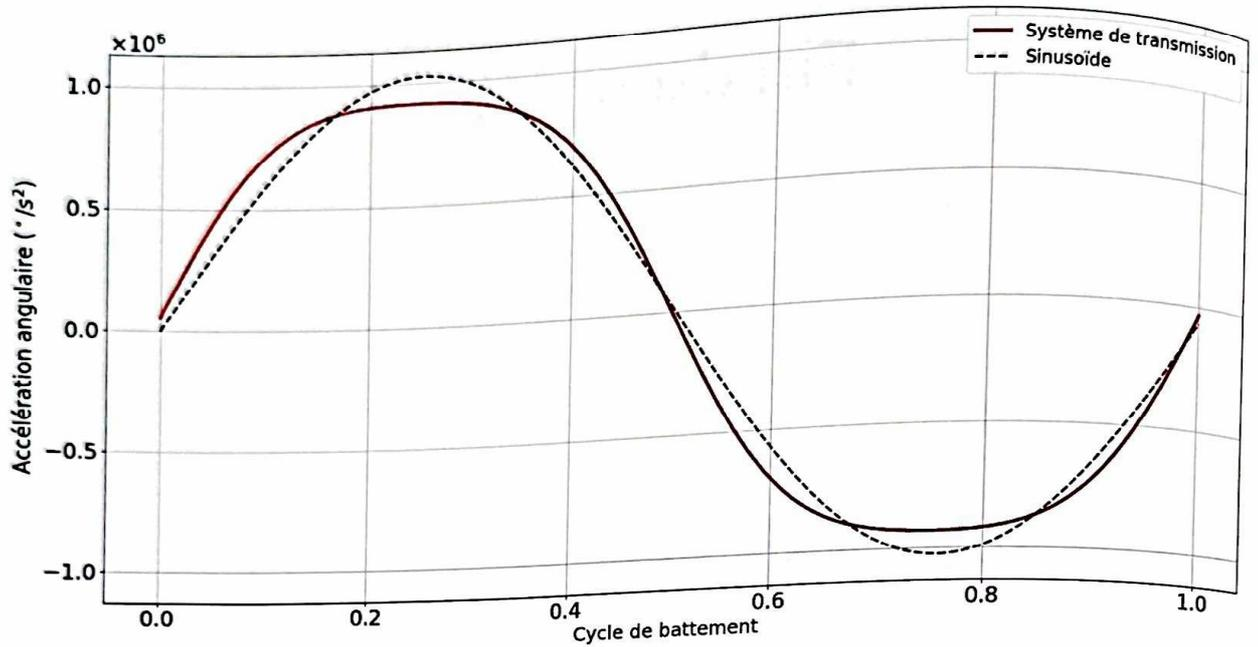
Figure 17 : Accélération angulaire durant un cycle de battement
