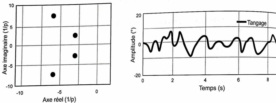
Figure 16: À gauche : position, dans le plan complexe, des pôles de la fonction de transfert en boucle fermée du vol de l'oiseau (pour le tangage), avec correction proportionnelle dérivée. À droite, mesure lors d'un essai de l'évolution de l'angle de tangage
