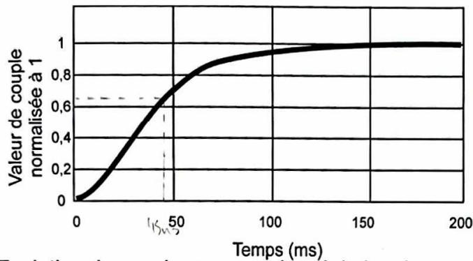
Figure 10: Evolution du couple  $C_{za}$  quand un échelon de couple  $C_z$  est demandé au servomoteur qui pilote les barres de stabilisation. L'échelle des ordonnées a été normalisée à 1
