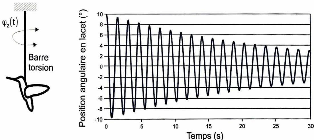
Figure 11: Evolution de l'angle de lacet pour une oscillation en torsion libre
