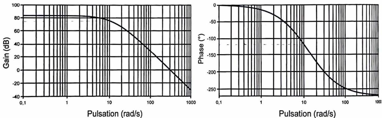
Figure 13: Diagrammes de Bode de la boucle ouverte pour l'asservissement en vitesse de rotation sur l'angle de lacet de l'oiseau. Les valeurs choisies pour le tracé sont  $K_i=1\text{N.m.s}$  et  $T_i=0,15\text{s}$
