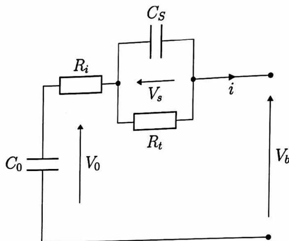
Figure 7 : Modèle de la batterie
