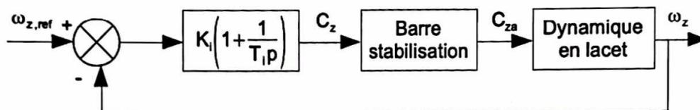
Figure 12 : Asservissement en vitesse de l'angle de lacet du drone
