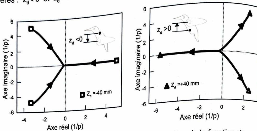
Figure 15: Position, dans le plan complexe, des pôles de la fonction de transfert du vol de l'oiseau en rotation en tangage
