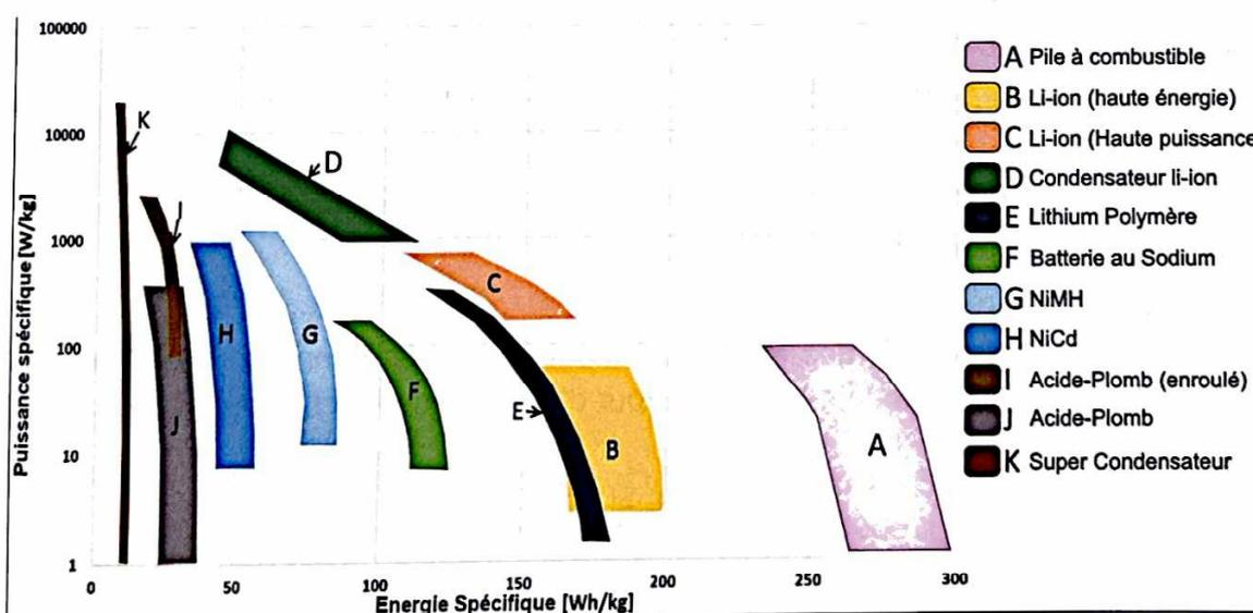
Figure 6 : Technologies de batterie dans le plan Puissance/Énergie spécifique
